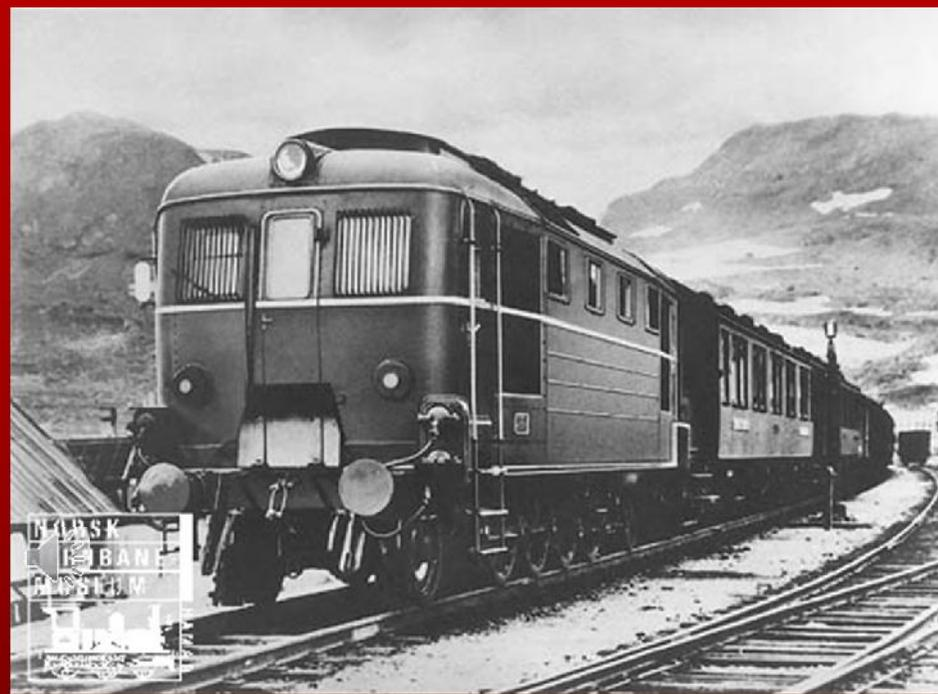
Die starke Rauchbelästigung in den Personenzügen, bedingt durch die vielen Tunnel und Lawinengalerien der Bergenbahn und die Uneinigkeit zur Elektrifizierung der Strecke, veranlasste die NSB eine dieselhydraulische 2.000 PS Lokomotive bei der Firma Krupp in Essen zu bestellen. Kriegsbeginn ließ die Produktion stark verspäten und erst im Januar 1942 traf die Lokomotive zu Probefahrten in Oslo ein.
